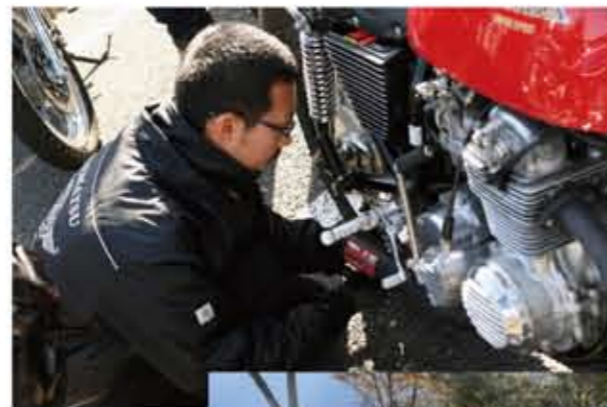
休憩時間中に脱落したモノに代わるボルトを手際よく取り付け一件落着！ウエマツのスタッフが伴走車でついてきてくれるのは心強い。
